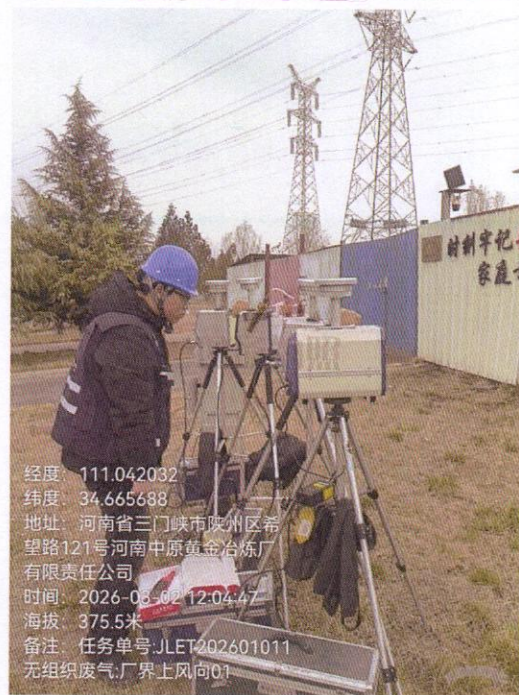
无组织废气采样照片
